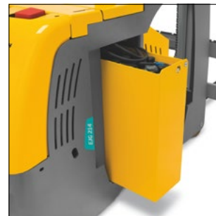
Extracción lateral de la batería (opcional)
