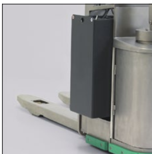
Preparada para el cambio de la batería: tapa de batería abierta y lateral desmontado
