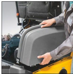
Piezas laterales fácilmente desmontables sin herramientas
